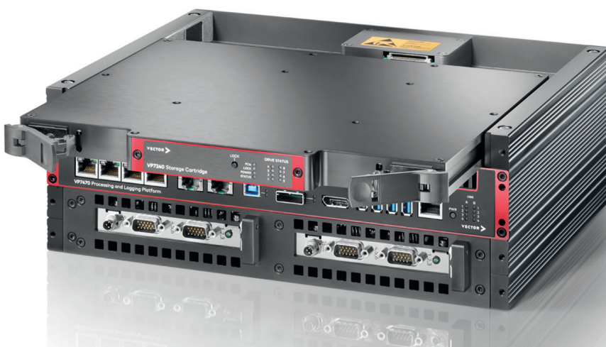
Bild 2: Einfaches Wechseln der Storage Cartridge am Vector VP7400. © Vector Informatik
